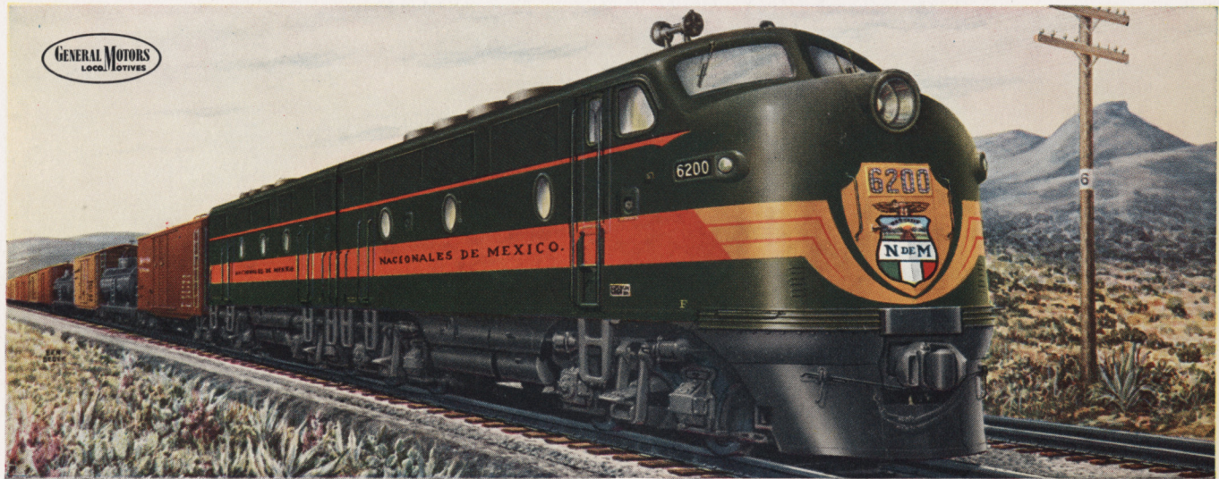
LOCOMOTORA DIESEL, DE 2700 H.P. PARA SERVICIO DE CARGA . . . DISEÑADA Y CONSTRUIDA POR LA ELECTRO-MOTIVE DIVISION GENERAL MOTORS LA GRANGE, ILLINOIS, U. S. A.
